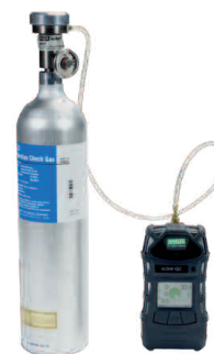
Test manuale con gas di prova
