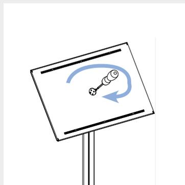
Per il cambio da orizzontale a verticale (o viceversa) allentare le viti e fissarle di nuovo dopo aver modificato l'orientamento.
