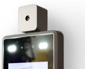
Telecamera dotata di sensori per riconoscere e mettere a fuoco il viso delle persone. Sensori per la luminosità che in caso di scarso illuminazione azionano le luci integrate per visualizzare il soggetto. I sensori permettono l'accensione e lo spegnimento del dispositivo automatico.
