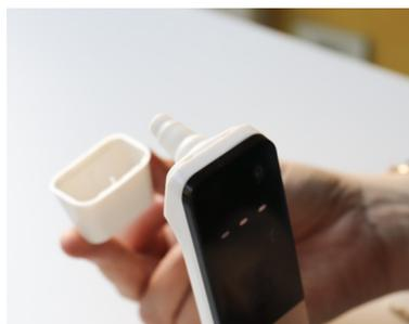
rimuovere il tappo dal lettore ad infrarossi e servirsi dell'apposito beccuccio per ricavare l'esatta temperatura auricolare da rilevare
