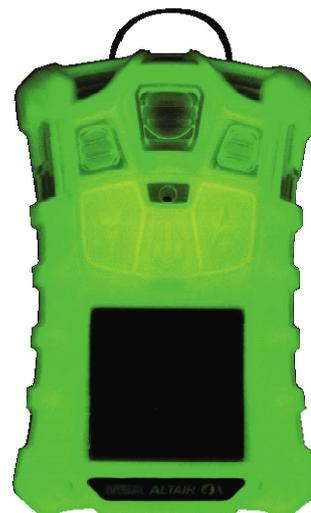
**ALTAIR 4X** è dotato come standard di un sistema di registrazione dei dati che permette di memorizzare fino a 50 ore di dati e 500 eventi. La successiva elaborazione dei dati permette di valutare nei dettagli l'intervento, di verificare la correttezza delle procedure e l'eventuale esposizione dell'operatore ad atmosfere pericolose.
