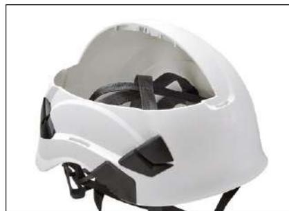
I caschi VERTEX dispongono di una bardatura in tessuto con fissaggio a sei punti che si adatta alla forma della testa per il massimo comfort. L'assorbimento degli urti avviene per deformazione del guscio esterno.
