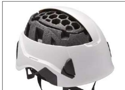
Il guscio interno dei caschi STRATO è progettato in due parti: EPP (polipropilene espanso) e EPS (polistirene espanso), per garantire maggiore leggerezza. L'assorbimento degli urti avviene per deformazione del guscio interno.
