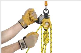
Sbloccaggio della camma e passaggio della corda nel freno integrato alla flangia principale per un controllo confortevole e preciso della calata.
