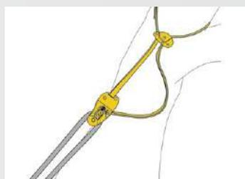
Il sistema permette varie configurazioni d'installazione sul ramo: avvolgimento o strozzatura. È dotato di un regolatore che consente di adattare con precisione la falsa forcella.
