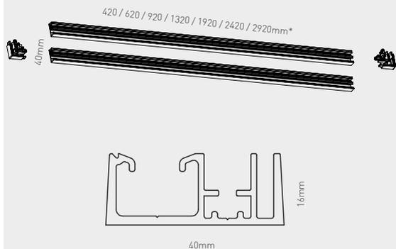
Il set comprende 2 profili in alluminio anodizzato e due angoli arrotondati in materiale sintetico color argento. Possibilità di acquistare i profili con taglio a 45°.
