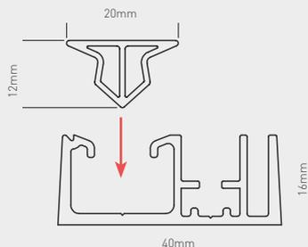
Il set comprende 2 profili in alluminio anodizzato e due angoli in materiale sintetico color argento. Incluso nel set anche il profilo ad incastro trasparente per banner.
