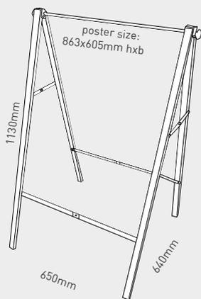
Struttura pieghevole in alluminio anodizzato color argento.
