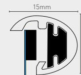
Il set comprende un listello magnetico e 2 profili in alluminio anodizzato color argento. Al loro interno è contenuto un sistema magnetico integrato che permetterà la perfetta aderenza della stampa. Completano il set, due tappi laterali con scanalature idonee a sostenere il sistema di fissaggio prescelto.
