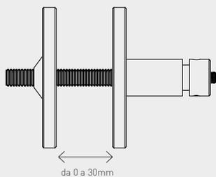
I pannelli che possono essere sostenuti con panel pinch possono avere uno spessore che può variare da 1 mm fino a un massimo di 30 mm.
