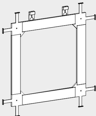
4 profili in alluminio anodizzato color argento, 4 angolari in materiale plastico, quantità necessaria per livellatura a parete e una cacciavite.
