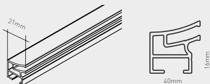
Cornice completa con profili in alluminio anodizzato color argento, angoli in metallo pressofuso color argento opaco.
