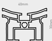
Cornice completa con profili in alluminio anodizzato color argento, angoli in metallo pressofuso color argento opaco.
