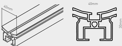
Cornice completa con profili in alluminio anodizzato color argento, angoli in metallo pressofuso color argento opaco.
