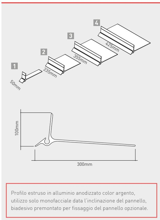
Profilo estruso in alluminio anodizzato color argento, utilizzo solo monofacciale data l'inclinazione del pannello, biadesivo premontato per fissaggio del pannello opzionale.
