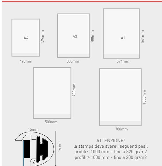
Il profilo di maGOMA Wall è realizzato interamente in alluminio anodizzato color argento. Al suo interno, si trova un magnete che permette la perfetta aderenza della stampa. Angoli in PA6 color grigio chiaro.
