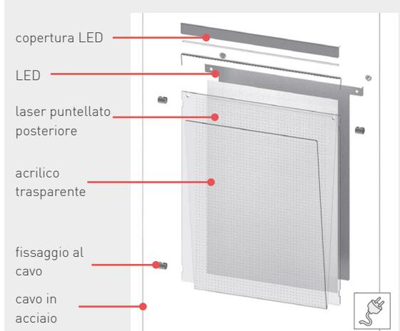
Materiale: La tasca Fly Shine è realizzata in plexiglass trasparente antiurto piegata a caldo e incisa a laser per migliorare la luminosità. Led compresi e già montati nella parte superiore della tasca.
