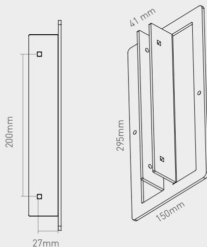
Metallo satinato di alta qualità color argento stampato a pressofusione, profili in alluminio anodizzato color argento. Regolabile orizzontalmente per posizionare e tendere perfettamente la bandiera.
