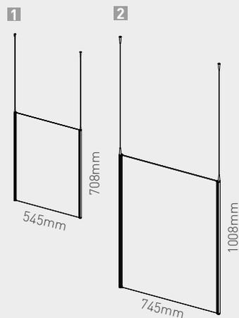
Tasca portaposter in acrilico trasparente con profili in alluminio anodizzato color argento, 2 tiranti per cavo adatti per l'accessorio fly loop in ottone cromato, 5 mt di cavo di acciaio inox.
