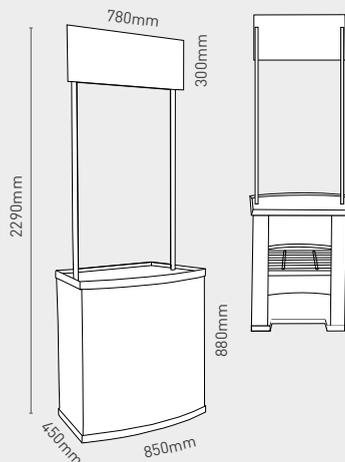
L'altezza della struttura è di 2290 mm, con una base di 850 mm. All'interno del counter è possibile stoccare cataloghi e oggetti.
