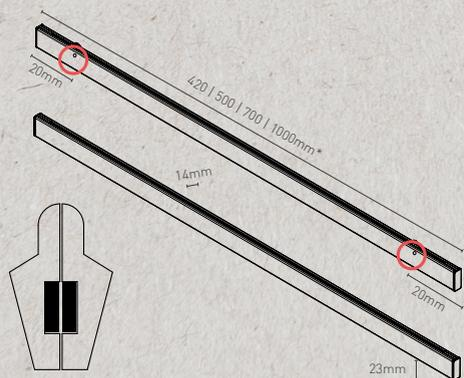
Il set comprende 2 profili in legno di faggio, al cui interno si trova un listello magnetico che garantisce alla stampa massima tenuta e nessun tipo di piega. La sezione del profilo ha dimensioni 23x14 mm
