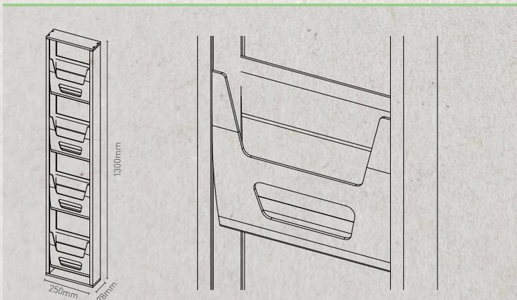
Wood Rack Wall è costituito da una struttura in legno di tiglio color noce e da 4 tasche in plexiglass formato A4, regolabili verticalmente senza l'utilizzo di attrezzi.
